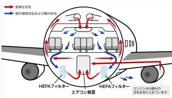
\* ボーイング787型機は、エンジンからではなく、航空機下部にあるエアコン装置から直接外気を取り入れています。
